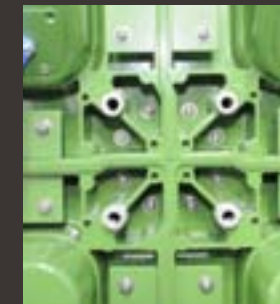
屏体固定安装
